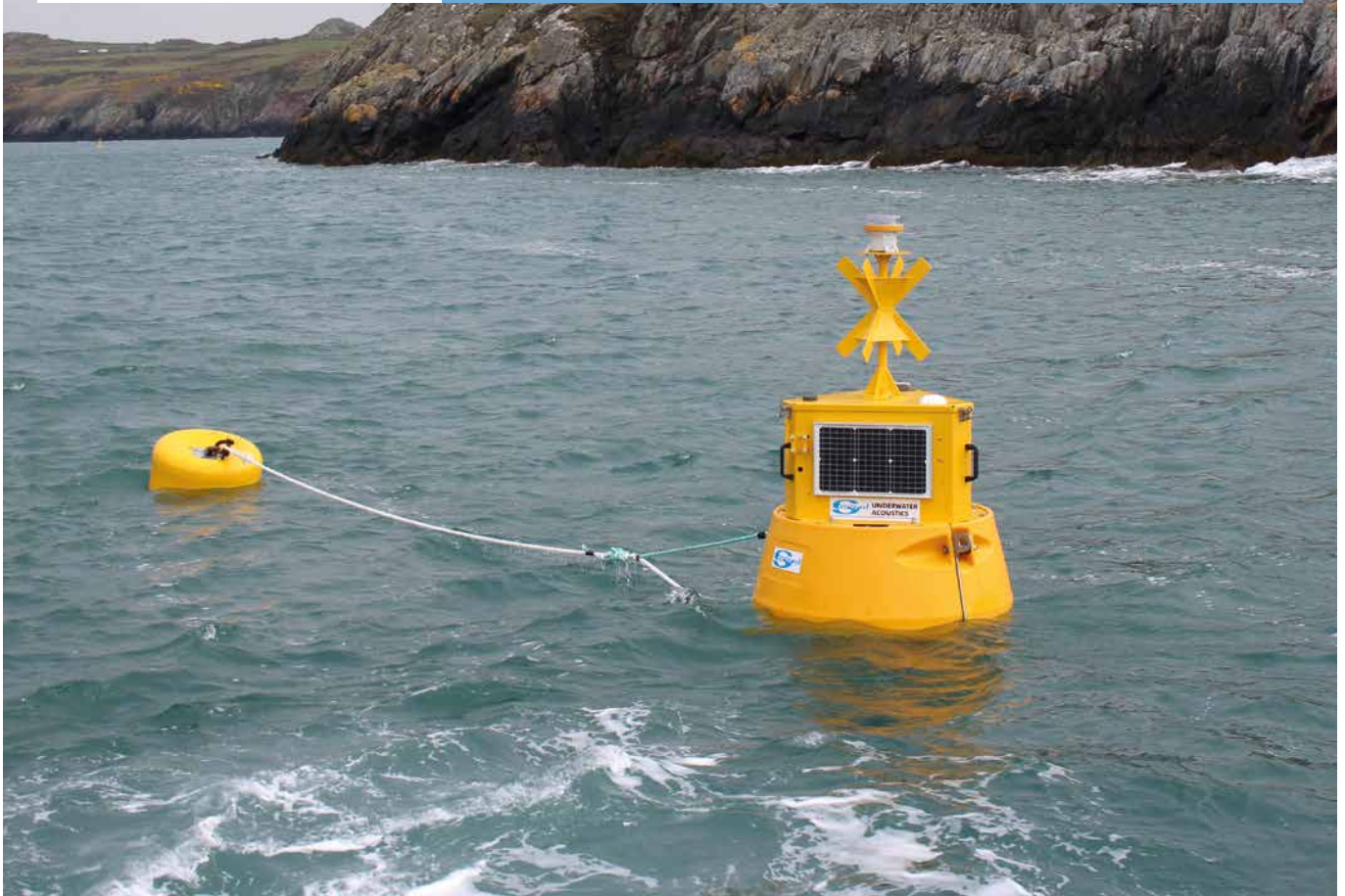
Bouée pour la détection automatique en temps réel de cétacés déployée au Pays de Galles en 2023
